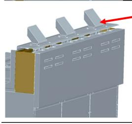
STEP 3: INSTALL THE FLUE DEFLECTORS (8239025) AS SHOWN.
